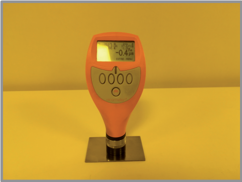
Control de espesor de emulsión ( eom )
