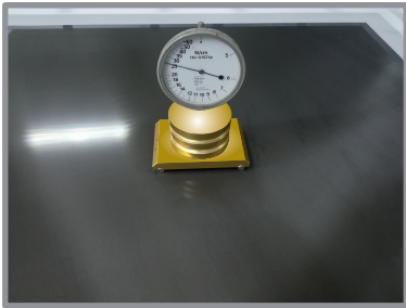
Control de tensión en pantalla
